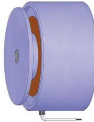
Gleichstrom-Hubmagnete mit 95mm Durchmesser. Runde Bauform für ziehende und drückende Kraftwirkung. Magnetkraft - Hub - Kennlinie ansteigend. Für Hübe von etwa 10,0mm.
